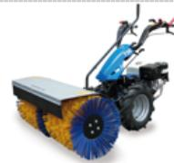
**STROJ ZA ČIŠĆENJE:** sa usmjeravajućom četkom sa posebnim vlaknima, koja omogućuje primjenu pored općeg čišćenja i za odstranjivanje snijega.
