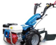
**ZAGRTAČ:** Dizajnirani i prilagođeni motokultivatorima, omogućavajući razumno korištenje i pripremu zemljišta, za pravljenje brazdi za sjetu ili navodnjavanje.
