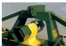
Menjalnik z ročko iz litega železa in ojačen priklop
