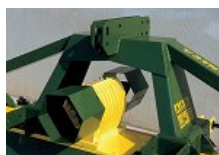
Menjalnik z ročko iz litega želaza in ojačen priklop
