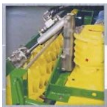
Podešavanje hidrauličnog valjka
